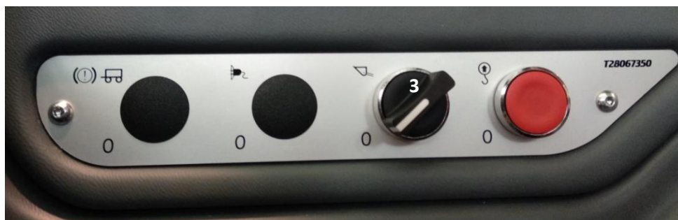
Przełącznik 3: Sterownik trybu ŁYŻKI
