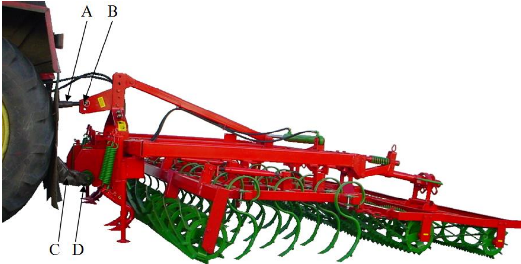
Rysunek 7 Podczepianie maszyny zawieszanej
