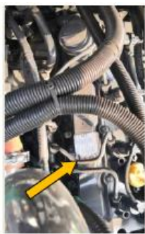
Tabliczka znamionowa na pokrywie cylindrów
