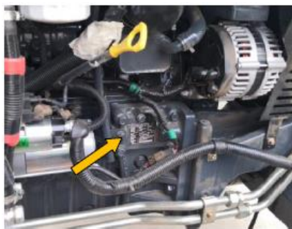
Tabliczka znamionowa na wsporniku miski olejowej
