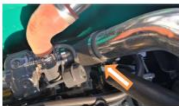
Opaska układu dolotowego suchego filtra powietrza
