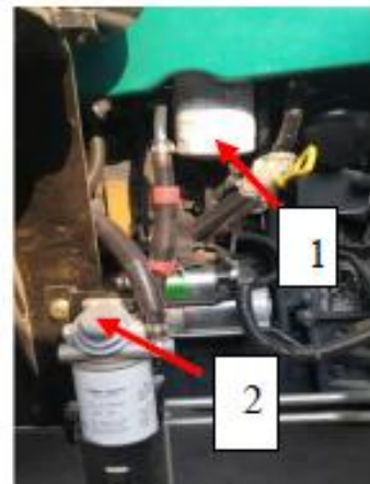
1. Filtr paliwa 2. Ręczna pompa paliwowa
