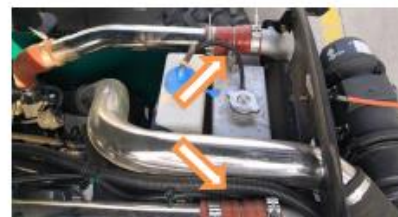
Opaska układu dolotowego suchego filtra powietrza
