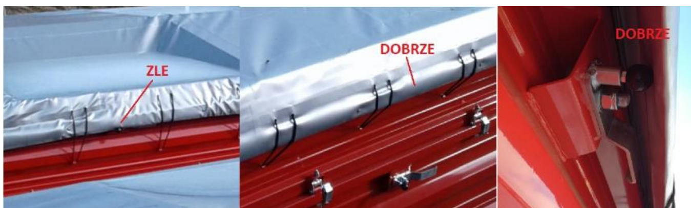
Rysunek 3. Prawidłowy naciąg plandeki
