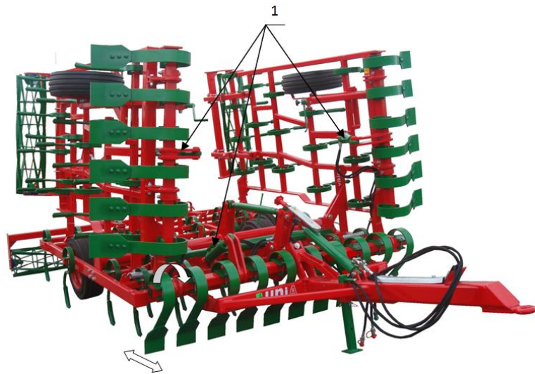
Rysunek 11 Regulacja hydrauliczna głębokości pracy włóki
