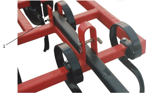
Rysunek 10 Regulacja głębokości pracy sekcji bocznych
