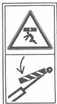
Rys 8. Nie sięgać w obszar zgniatania, jeśli elementy mogą się poruszać (z lewej strony wysięgnika).
