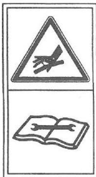
Rys 7. Unikać oddziaływania cieczy wypływającej pod ciśnieniem. Zapoznać się z instrukcją obsługi w zakresie czynności obsługowych (z lewej strony wysięgnika).
