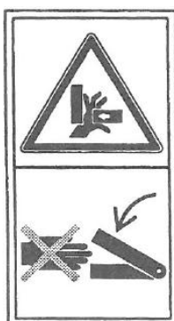
Rys 8. Nie sięgać w obszar zgniatania, jeśli elementy mogą się poruszać (z lewej strony wysięgnika).
