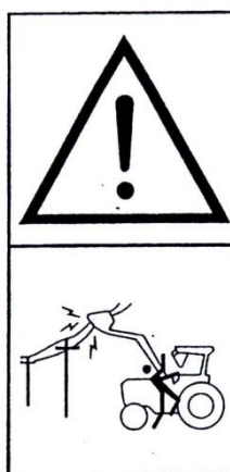
Rys. 5. Porażenie prądem (umieszczony z lewej strony wysięgnika)
