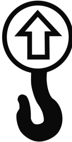
Rys.12. Hak – punkt zaczepienia do podnoszenia (po obu stronach).
