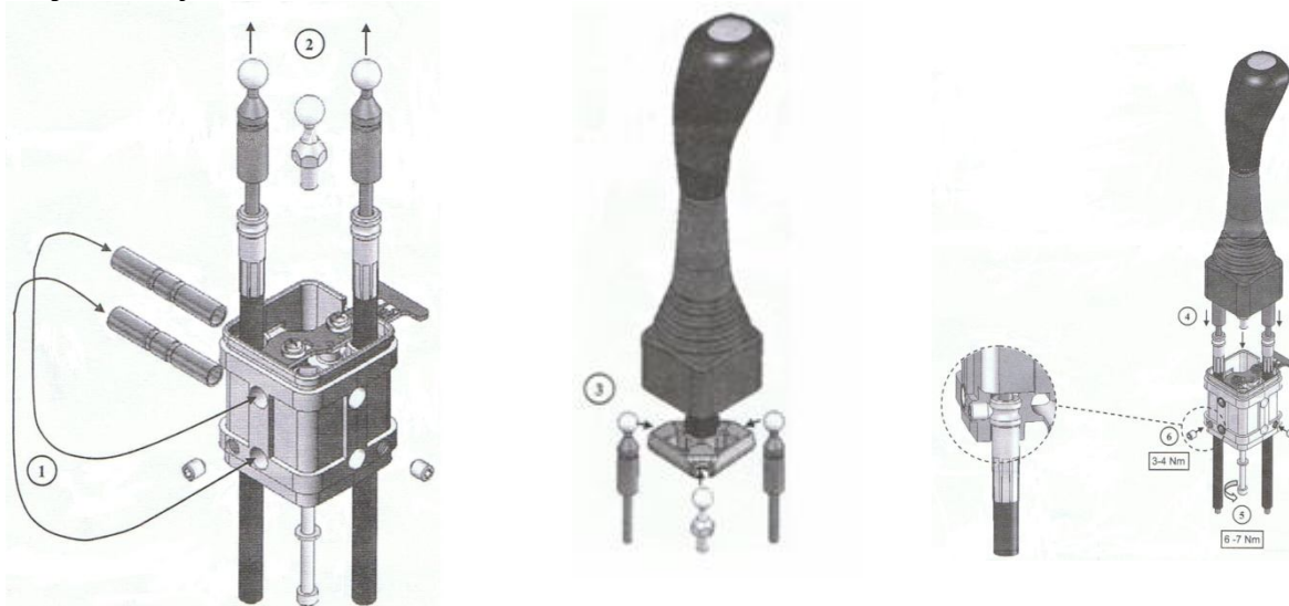
Rys 14. Podłączenie cięgieł Bowdena do sterownika
