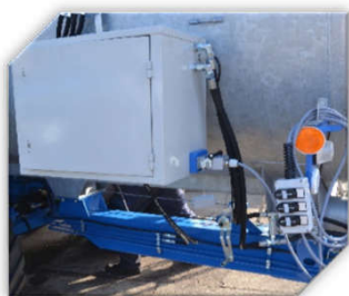
Skrzynka z elektrozaworami + panel sterujący
