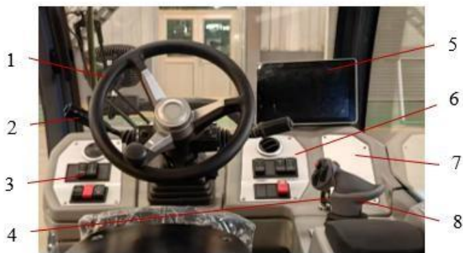
Rys. 4-1 Tablica rozdzielcza i mechanizm sterujący
