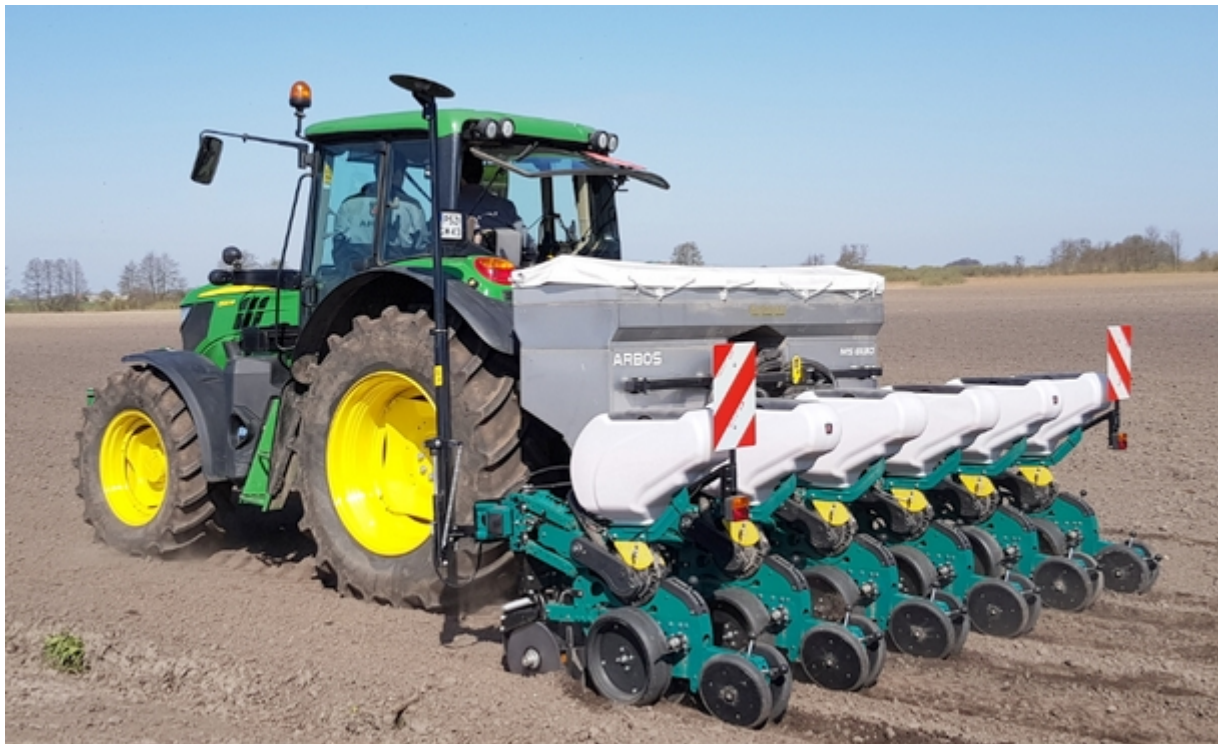
Fot. Siewnik punktowy ARBOS MS 8130 na ramie teleskopowej, z ciągnikiem John Deere, podczas wysiewu kukurydzy na ziarno (rozstaw między rzędami 75 cm).
