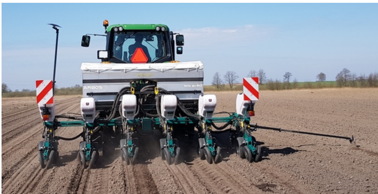
Fot. Siewnik punktowy ARBOS MS 8130 na ramie teleskopowej, z ciągnikiem John Deere, podczas wysiewu kukurydzy na ziarno (rozstaw między rzędami 75 cm).
