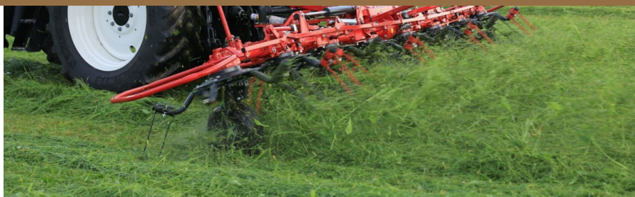
Przetrzęsacz 8-wirnikowy, zawieszany firmy SIP typ SPIDER 815/8 podczas przetrzясania trawy
