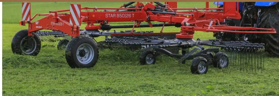
Zaczeplona zgrabiarka 2-wirnikowa firmy SIP typ STAR 850/26 T podczas zgrabiania trawy
