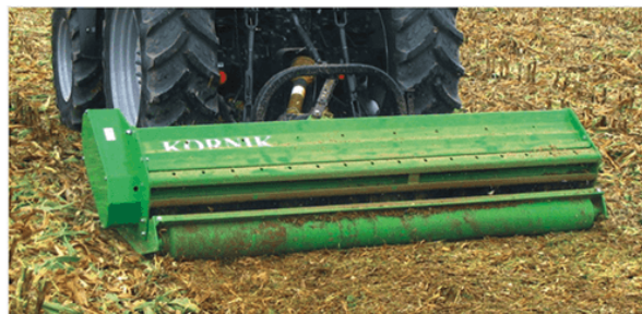
Kornik XL rozdrabniający resztki poźniwne w uprawie kukurydzy.
