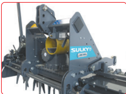
1 Tête d'attelage monobloc pour recevoir des semoirs à forte capacité de trémie
