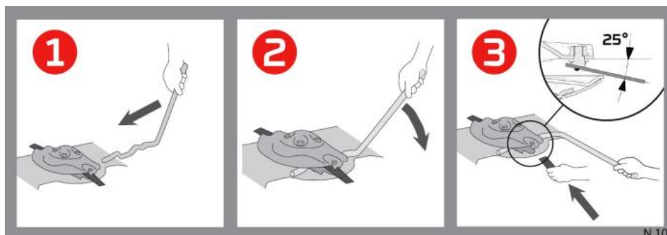
Rys. 22. Szybka wymiana noży tnących
