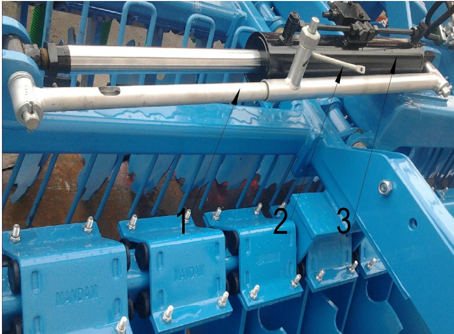
Rys. 3 Blokada mechaniczna TAL-C: 1- zabezpieczenie mechaniczne, 2- ramie blokady ciągnięte sznurkiem, 3 - siłownik
