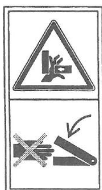
Rys 8. Nie sięgać w obszar zginiatania, jeśli elementy mogą się poruszać (z lewej strony wysięgnika).
