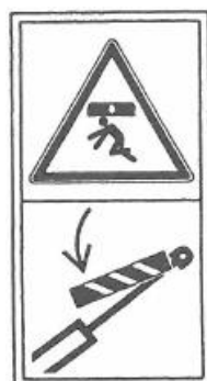
Rys 8. Nie sięgać w obszar zginiatania, jeśli elementy mogą się poruszać (z lewej strony wysięgnika).
