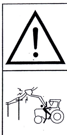
Rys. 5. Porażenie prądem (umieszczony z lewej strony wysięgnika)
