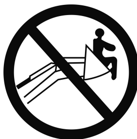
Rys. 11. Zabrania się przewożenia osób w łyżce ładowacza, nie jeździć na maszynie jak ładowacz jest bez osprzętu (znak umieszczony po obu stronach wysięgnika).
