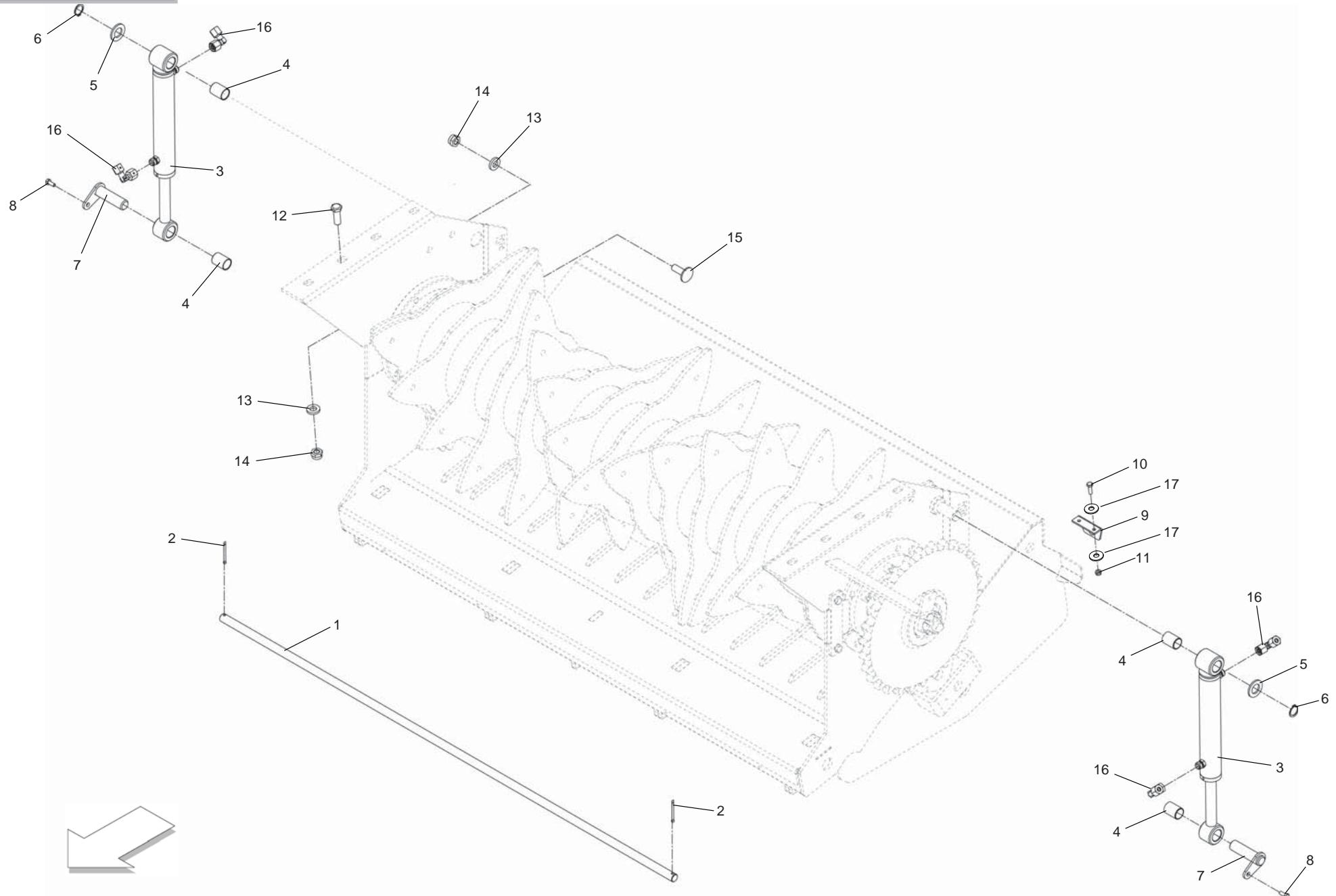
**ROTOR: MARTINETTO FONDO + VITI UNIONE TELAIO**
