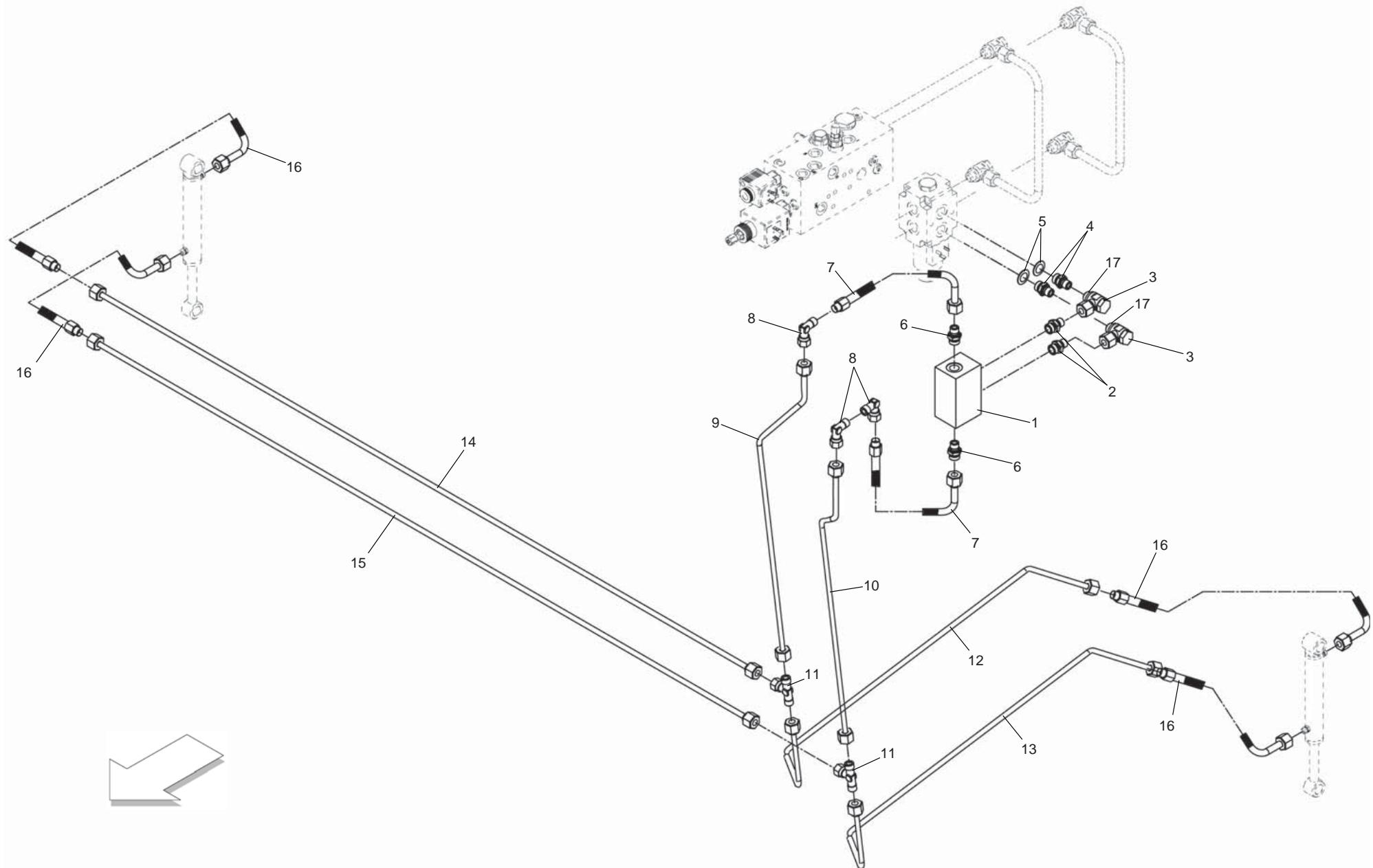
**IMPIANTO IDRAULICO FONDO-ROTOR**
