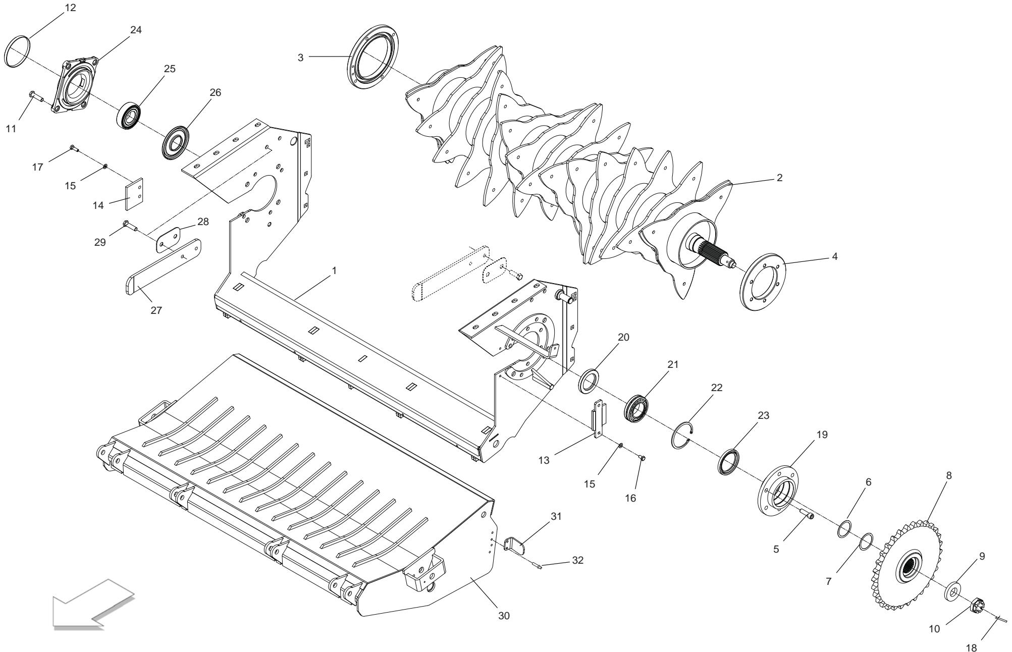
**ROTOR: TELAIO + ROTORE**
