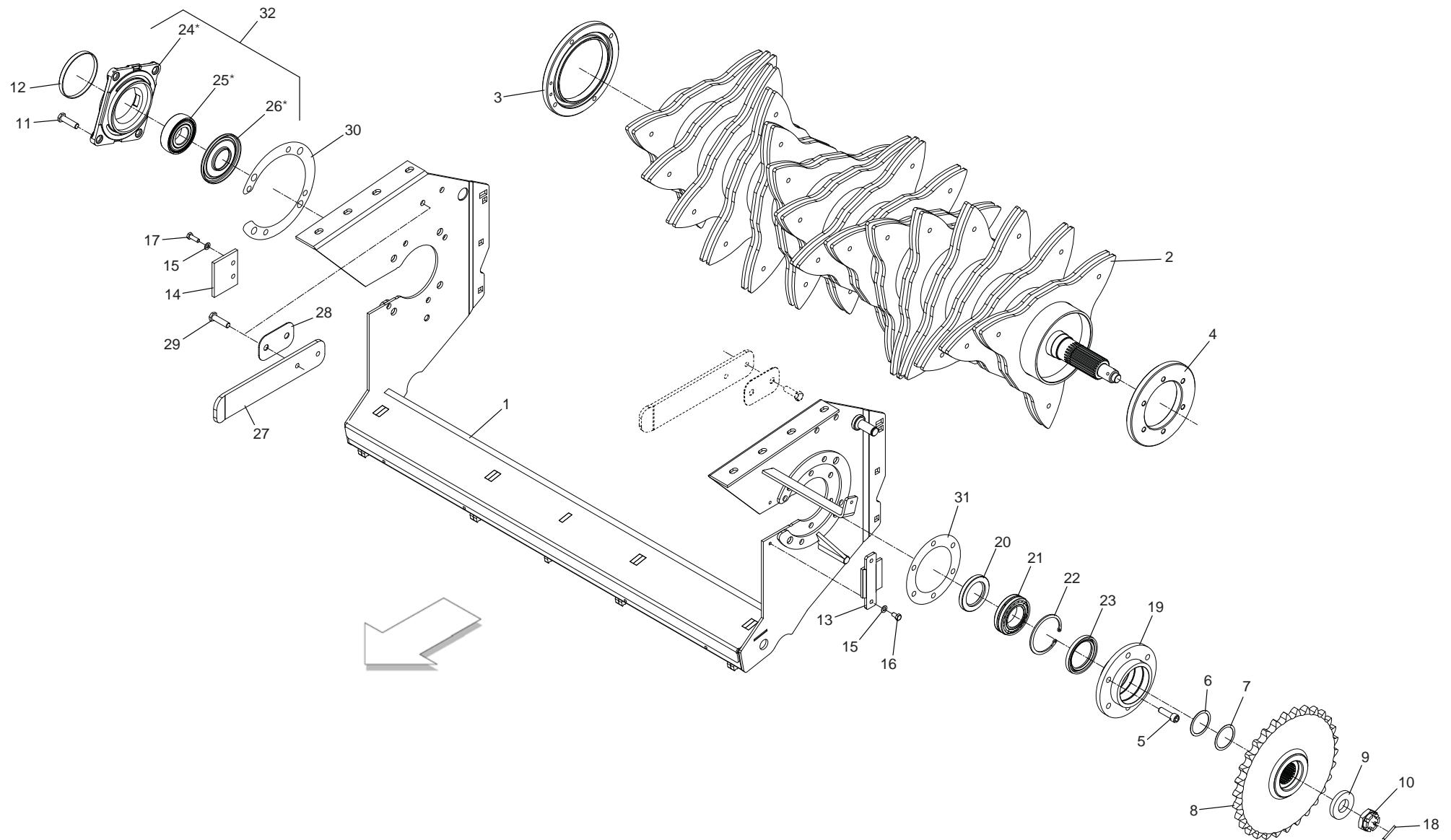
**CUT 15: TELAIO + ROTORE**
