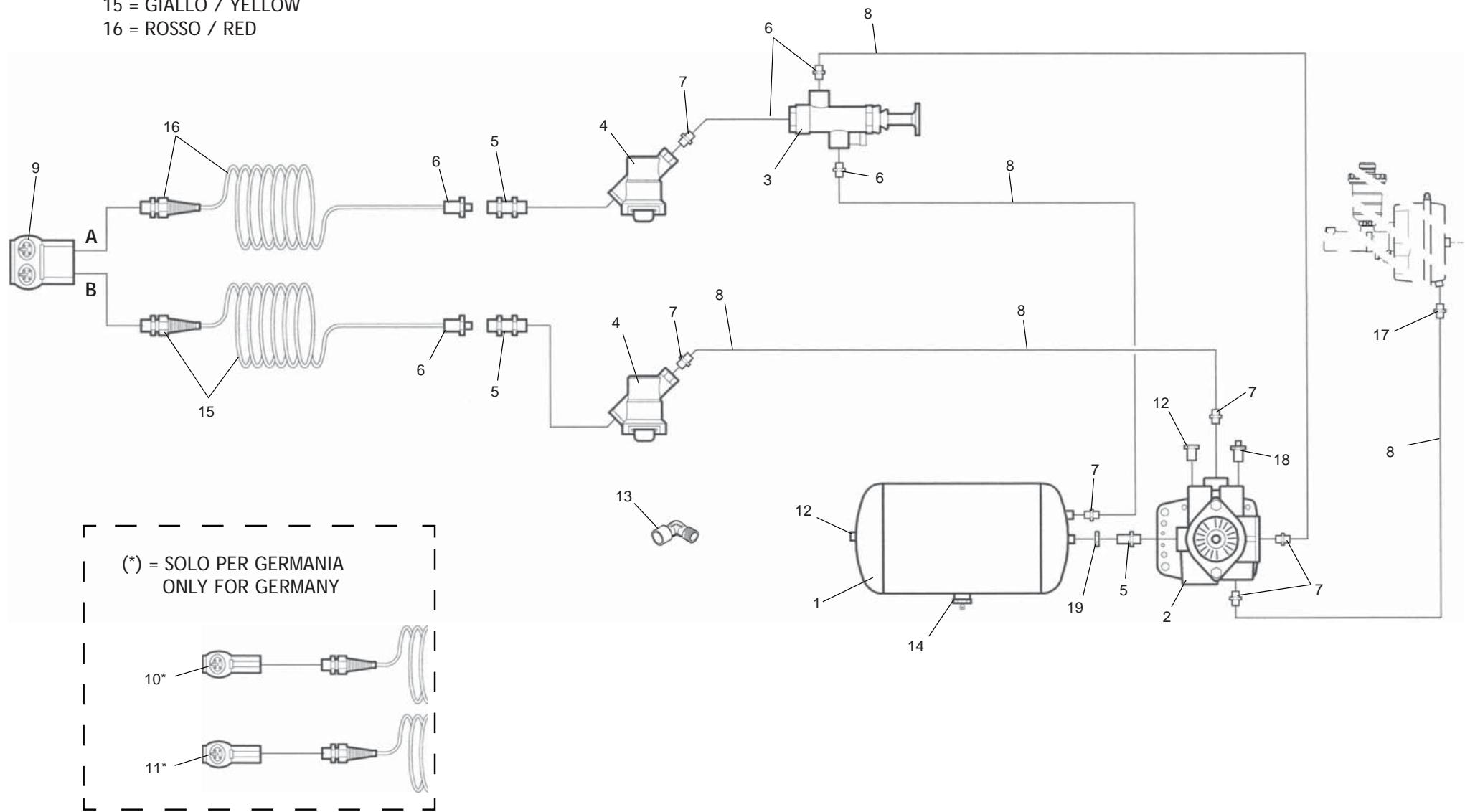
**FRENO PNEUMO-IDRAULICO (PARTE 2)**
