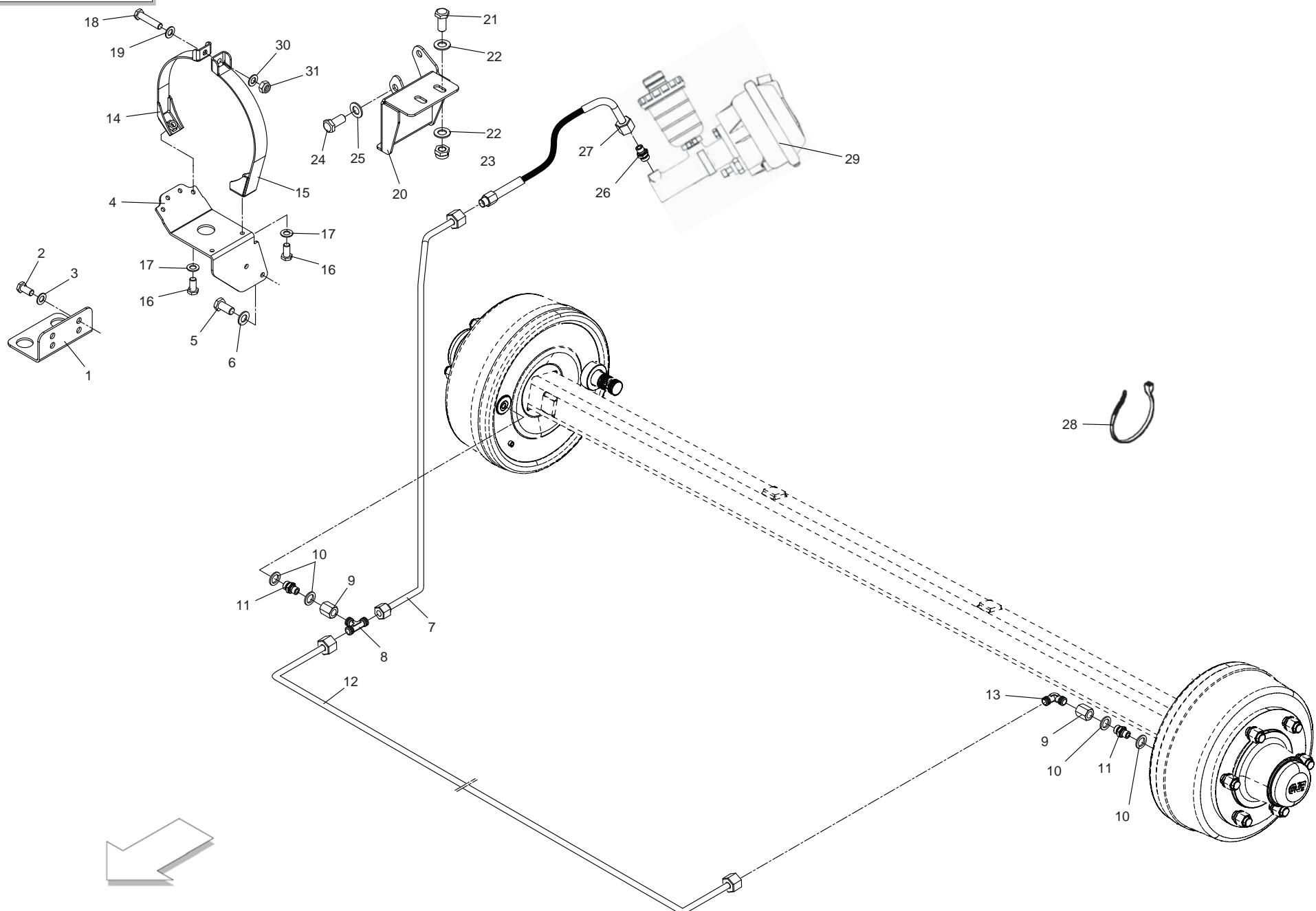
**FRENO PNEUMO-IDRAULICO (PARTE 1)**
