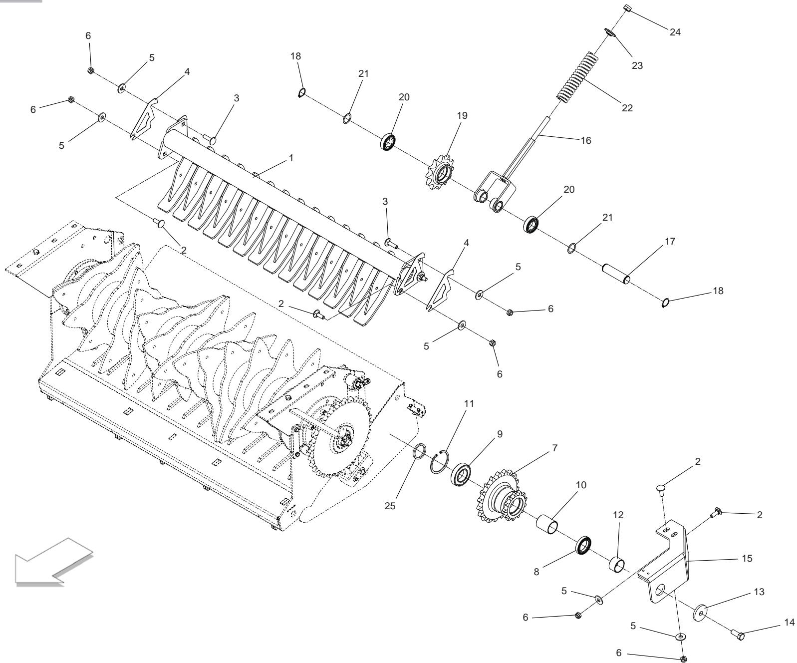
**ROTOR: BARRA RASCHIATORE + PORTA SENSORE**
