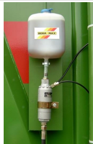
Ilustracja: instalacja smarująca łańcuchów napędowych urządzenia frezującego
