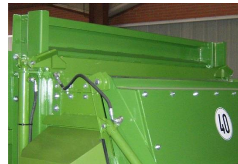
Ilustracja: Nakładki zasuwy spiętrzającej
