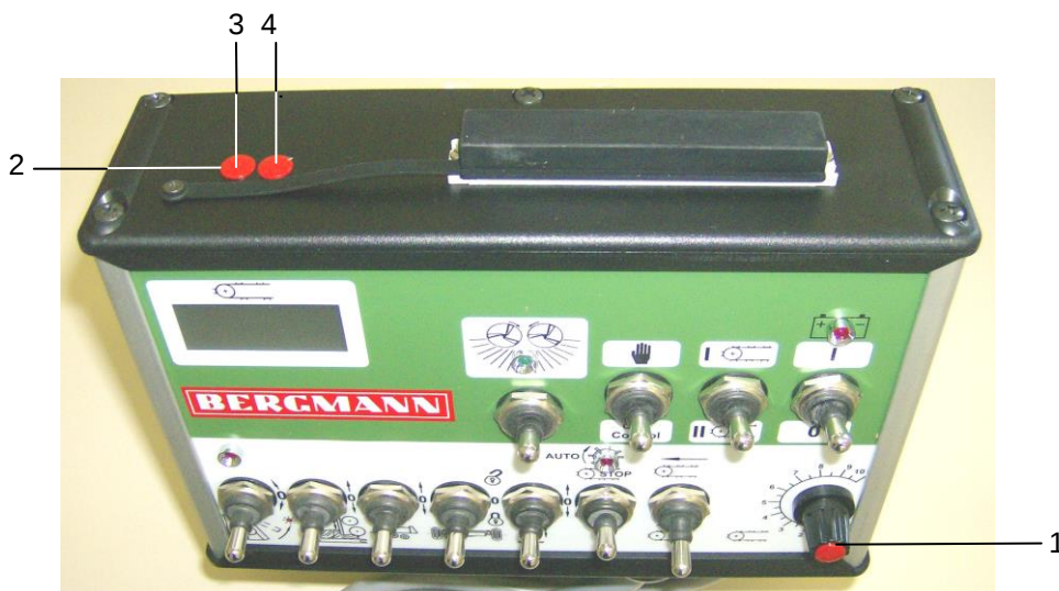
Ilustr.: Potencjometr w sterowniku komfortowym
