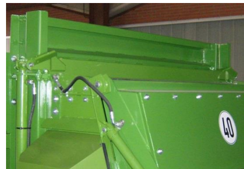
Ilustracja: Nakładki zasuwy spiętrzającej
