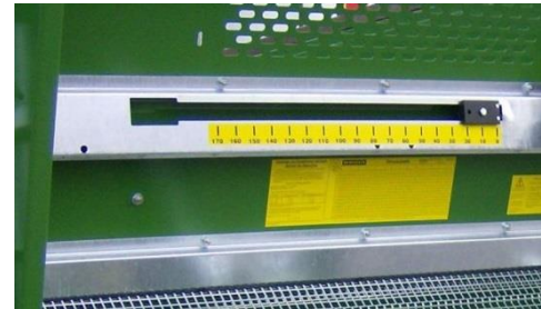
Ilustracja: Wskaźnik wysokości zasuwy spiętrzającej
