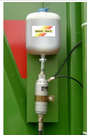
Ilustracja: instalacja smarująca łańcuchów napędowych urządzenia frezującego
