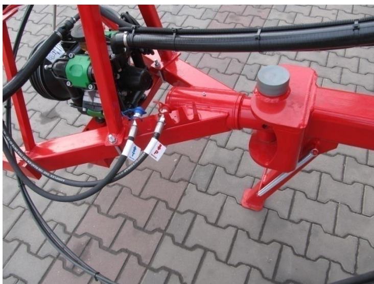
Rysunek 2 Przewody hydrauliczne umocowane prawidłowo.
