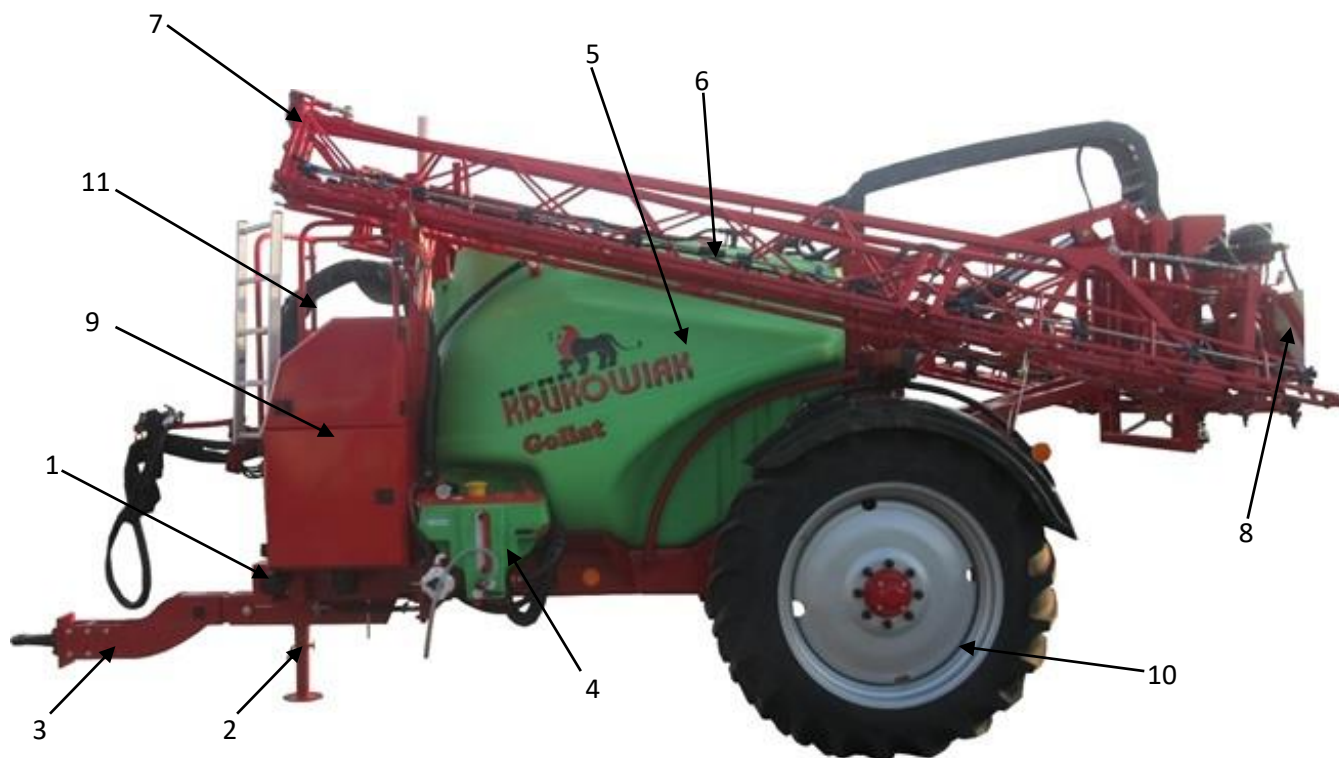
Rys. 7. Budowa opryskiwaczy GOLIAT 2500/3000 PHN.
