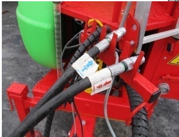
Rysunek 2 Przewody hydrauliczne umocowane prawidłowo.
