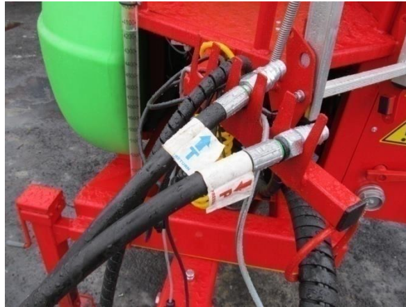
Rysunek 2 Przewody hydrauliczne umocowane prawidłowo.
