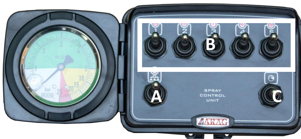
Rysunek 19 Panel sterowania układem cieczowym opryskiwacza GOLIAT 3600/4200 ALU.
