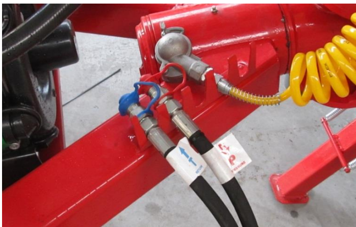
Rysunek 2 Przewody hydrauliczne umocowane prawidłowo.
