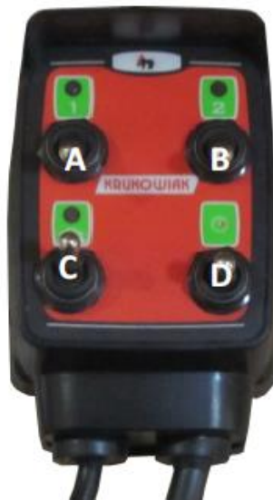
Rysunek 18 Panel sterowania układem cieczowym opryskiwacza.
