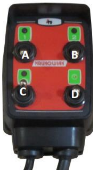
Rysunek 18 Panel sterowania układem cieczowym opryskiwacza.
