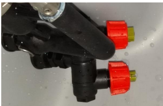
Rys. 19. Króćce z rozpylaczami rozwadniającymi
