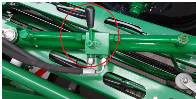
Rys. 24 Dźwignia zamka na siłowniku rozkładania ostatniego skrzydła.
