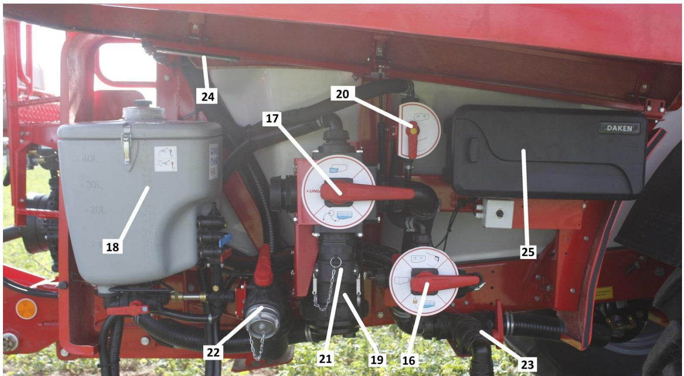
Rys. 2. Budowa opryskiwacza: 1 - rama, 2- koła jezdne, 3 - dyszel, 4 – stopa podporowa, 5 - zbiornik główny, 6 - otwór wlewowy zbiornika głównego, 7 – pompa, 8 –belka polowa, 9 – podest obsługowy z drabinką, 10 – oświetlenie nocne belki, 11 – myjka zewnętrzna*, 12 – oświetlenie drogowe, 13 – zbiornik wody do mycia rąk, 14 - zawór hamulcowy, 15 – osłona osprzętu, 16 – zawór pięciodrogowy tłoczny, 17 – zawór pięciodrogowy ssawny, 18 – rozwadniacz eżektorowy, 19 – filtr ssawny, 20 – dodatkowy zawór trójdrogowy mycia zewnętrznego lub wewnętrznego*, 21 – przyłącze do napełniania (cam-lock), 22 – przyłącze do napełniania (hydrantowe), 23 – zawór spustowy, 24 – oświetlenie nocne rozwadniacza, 25 – skrzynka na akcesoria
