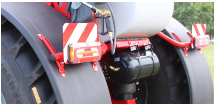
Rys. 59. Urządzenia świetlno-ostrzegawcze - biało-czerwona tablica z lampą zespoloną oraz tablica wyróżniająca pojazdy wolno poruszające się
