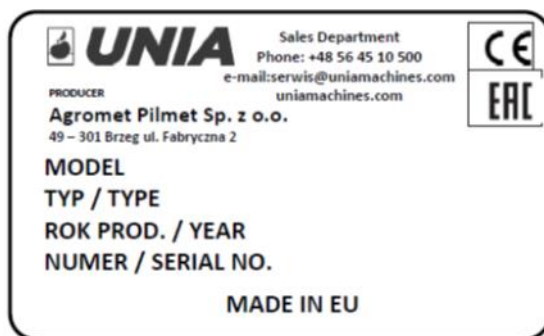
Rys. 1.2 – Wzór tabliczki znamionowej
