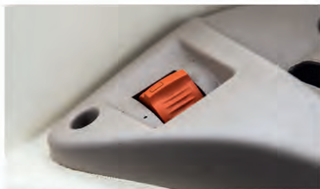
Niewielki przycisk na prawej konsoli modelu Advance reguluje czułość działania rewersu.
