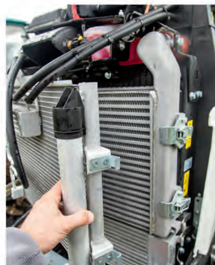
Codzienną obsługę traktora ułatwiają odchylane chłodnice.
