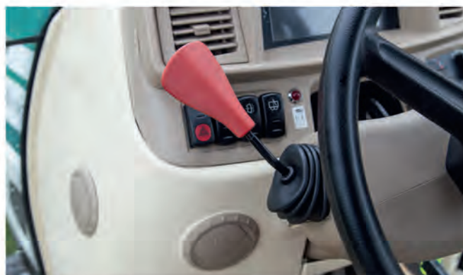
Arbos w wersji Advance ma rewers elektrohydrauliczny, który nie wymaga użycia sprzęgła.
