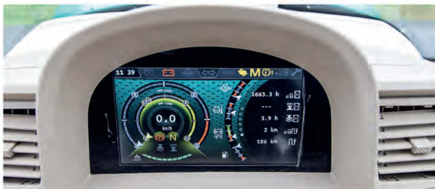
Na desce rozdzielczej dominuje elektroniczny wyświetlacz. Naszym zdaniem wskazania obrotomierza są mało czytelne.
