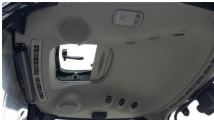
Nadmuch ciepłego powietrza
