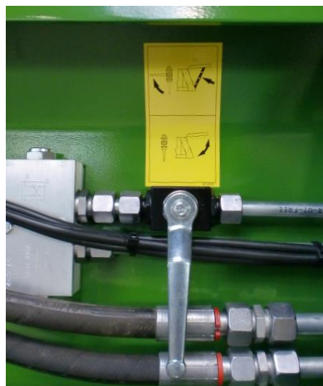
Ilustracja: Zawór odcinający tylnej klapy
