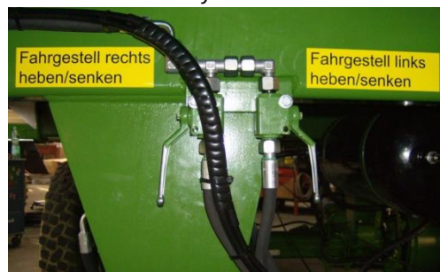
Ilustracja: Zawory otwarte, unoszenie/opuszczanie prawa/lewa strona
