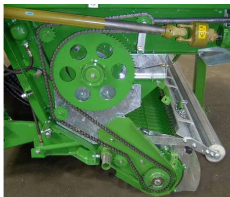
Ilustracja: Napęd podbieraka
