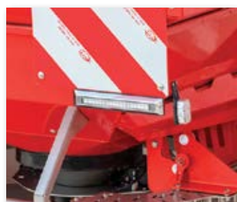
Zestaw tylnych świateł LED (standard w modelu PRIMO EW - E/EW-ISOTRONIC)
