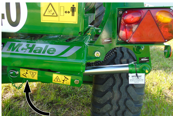
Blokada transportowa, odblokowana
