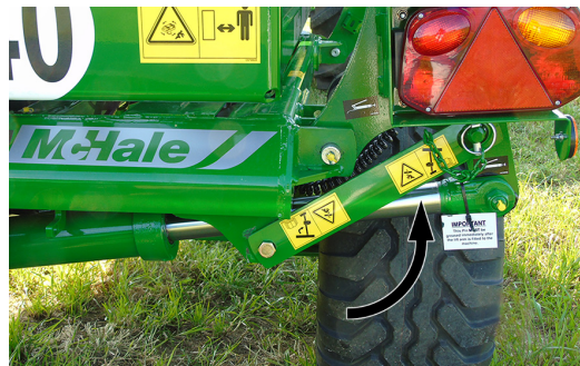
Blokada transportowa w pozycji zablokowanej
