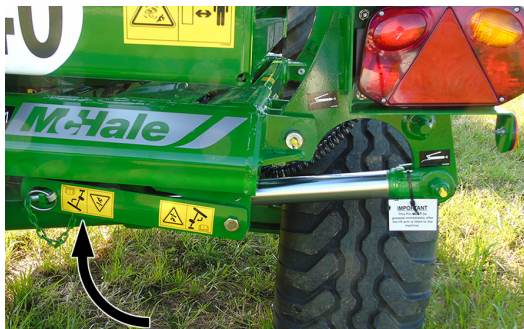
Blokada transportowa, odblokowana
