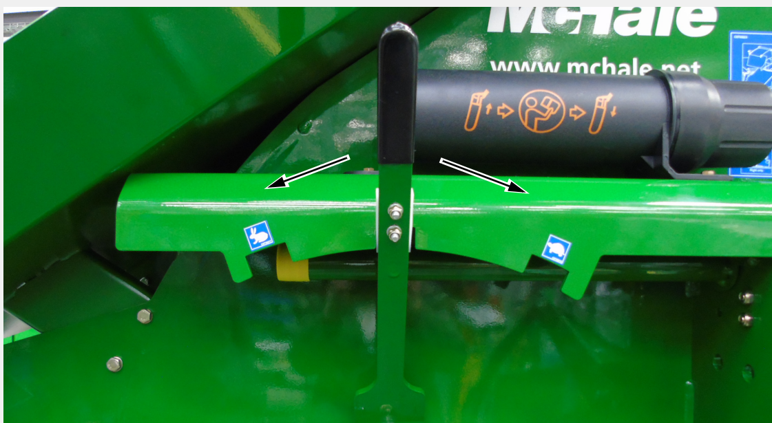
Dobieranie biegów przekładni (pokazano w pozycji neutralnej)
