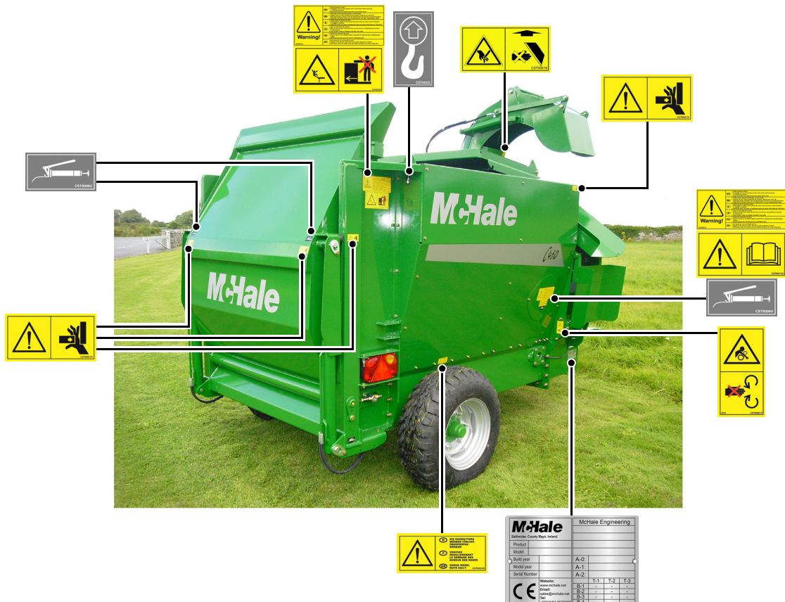
Etykiety z tyłu urządzenia (pokazano model C460)
