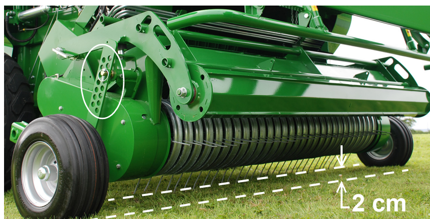
Regulacja wysokości motowidła zbieraka
