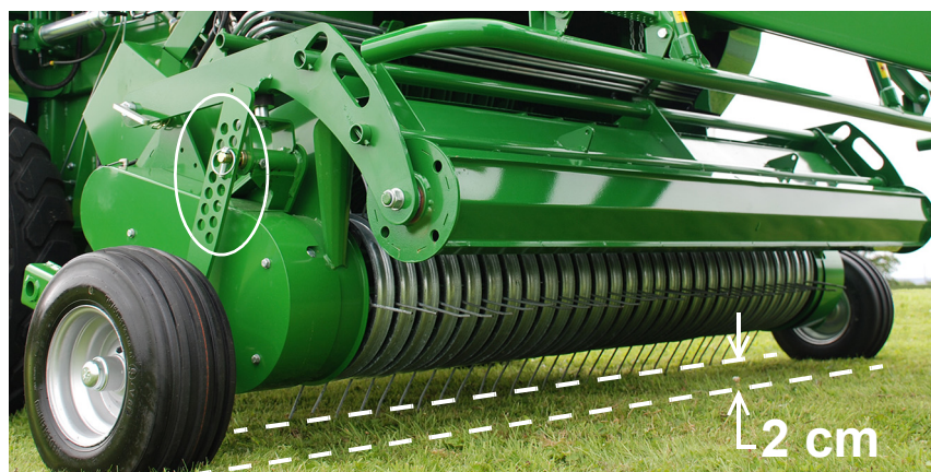
Regulacja wysokości motowidła zbieraka
