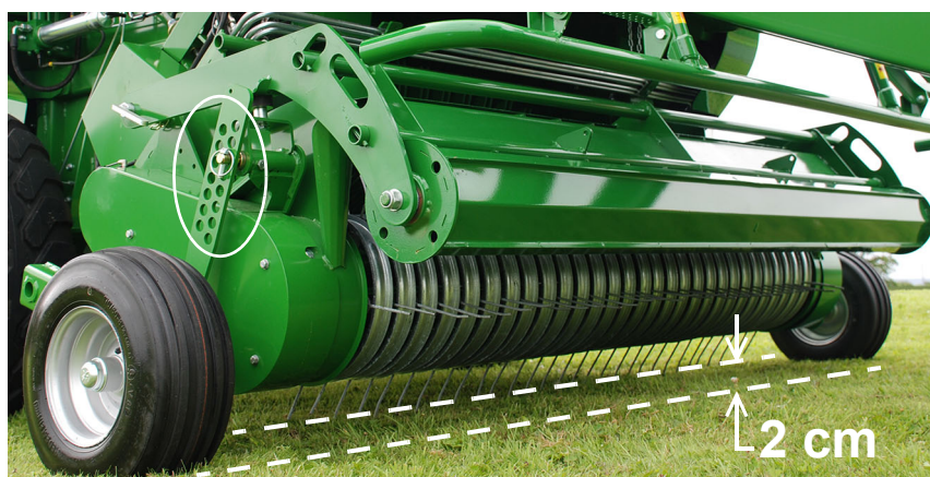
Regulacja wysokości motowidła zbieraka
