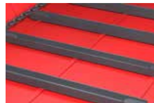
Podłoga napędzana hydraulicznie z możliwością zmiany prędkości
