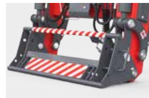
Mocowanie osprzętu - ramka EURO
