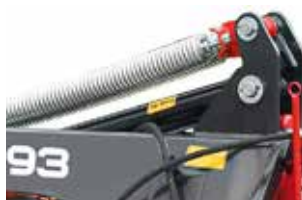
Siłownik hydrauliczny - Ułatwiający manewrowanie i transport maszyny. Jednostronnego działania.
