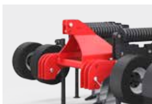
Regulacja mechaniczna głębokości pracy -
