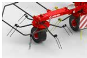
Palce przetrząsacza - Wykonane z drutu o średnicy 10 mm.
