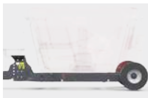
Konstrukcja ramowa - obniżona
