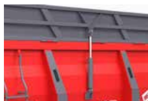
Możliwość opuszczania i podnoszenia nadstawki hydraulicznej. Sterowanie odbywa się z kabiny ciągnika
