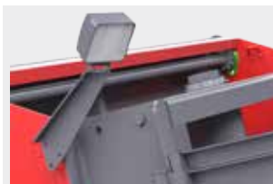
Oświetlenie robocze do pracy po zmroku - -szperacze
