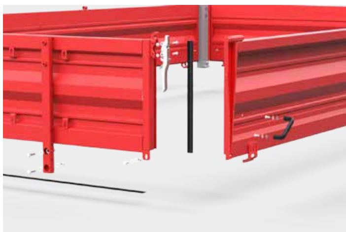
Przyczepy posiadają specjalne uszczelki które zapewniają odpowiednią szczelność
