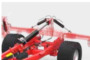
Hydrauliczna regulacja pracy poprzez nośnik U910
