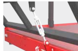
System blokujący położenia borty
