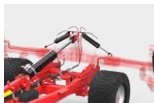
Hydrauliczna regulacja pracy poprzez nośnik U910
