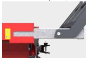
Cynkowana rama wydłużająca przestrzeń ładunkową o 1000mm
