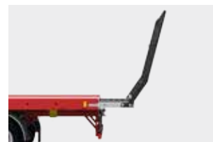
W nowej platformie do bel wysuw z 800 mm został wydłużony do 1000 mm.
