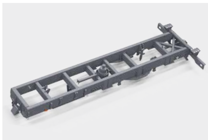
Rama nośna wykonana z rury prostokątnej
