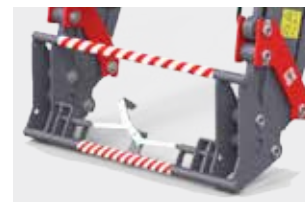
Mocowanie osprzętu - ramka EURO
