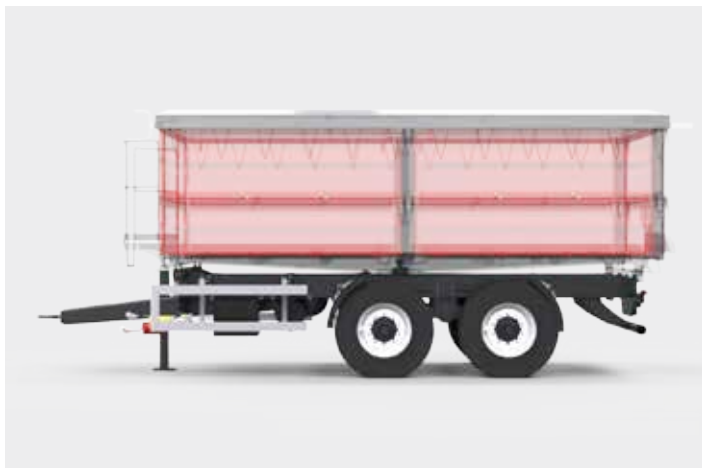
Zastosowano podwozie typu tandem - większy komfort i bezpieczeństwo jazdy
