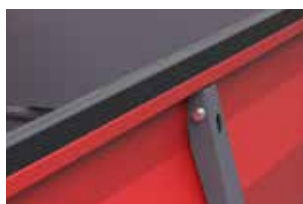
Burty osłaniane przez gumowe listwy zabezpieczające przed uszkodzeniem
