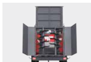
Hydraulicznie podnoszona zasawa gilotynowa, w dolnej części uszczelniona pasem gumowym
