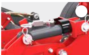
Regulacja hydrauliczna głębokości pracy - zapewnia precyzyjną jej regulację podkładkami
