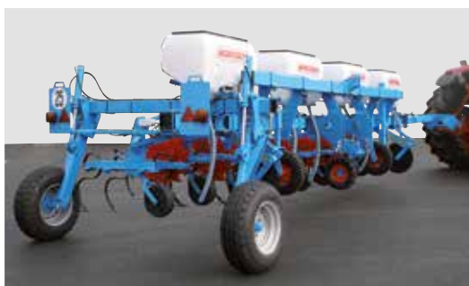
Pielnik na ramie sztywnej TIP 5", 8-rzędowy, rozstaw między rzędami 70 cm, w pozycji transportowej
