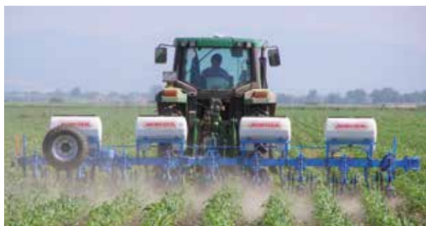
Pielnik na ramie sztywnej TIP 5", 8-rzędowy, rozstaw między rzędami 70 cm, w trakcie pracy
