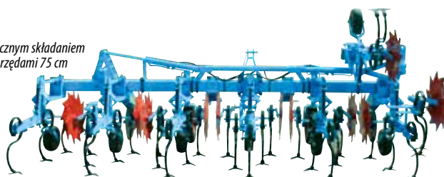
Pielnik o «dużej szerokości», składany hydraulicznie 12/8-rzędowy, o rozstawie między rzędami 75 cm
