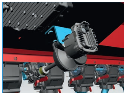
Podsiewacz nawozów FertiSmart Z napędem elektrycznym ISM (Integrated Smart Motors) Jeden silnik elektryczny na kilka dozowników
