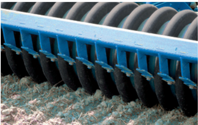
Wał gumowy (śr. 58 cm) z zębami wyrównującymi (308 kg/m) przed wałem lub alternatywnie z zakrzywionymi talerzami (320 kg/m).
