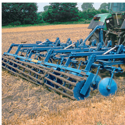
Wał rurowy (śr. 54 cm) z zakrzywionymi talerzami przed wałem.
