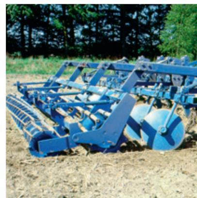
Tandemowy wał tylny = wał rurowy (śr. 44 cm) i kruszący (śr. 35 cm) z zakrzywionymi talerzami.
