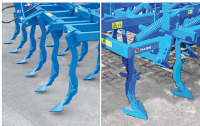
Zęby sztywne z zabezpieczeniem na śrubę ścinaną.
