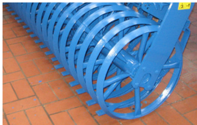
Wał metalowy pierścieniowy (śr. 60 cm).
