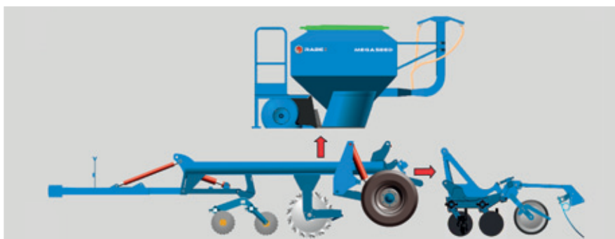
Field Bird 6000 KAL może być przystosowany do pracy jako siewnik do siewu uproszczonego MegaSeed.
