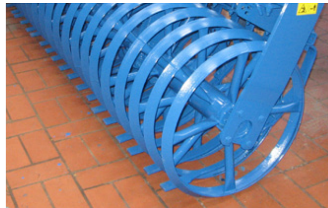
Wał metalowy pierścieniowy (śr. 60 cm).
