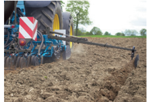
Boczne znaczniki przejazdów składane hydraulicznie do pionu.
