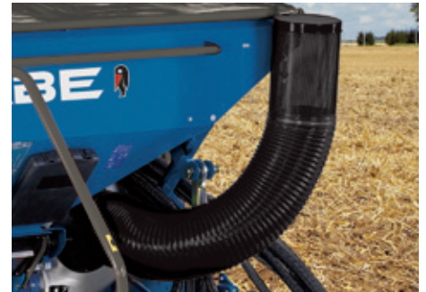
Duża, 6-calowa turbina , z otworem zasysającym powietrze o dużej średnicy i z filtrem powietrza, w celu zapewnienia optymalnego działania turbiny w nawet najbardziej zapyłonych warunkach.
