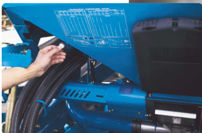
Napęd elektryczny dozownika: opróżnianie dozownika za pomocą przycisku rozruchowego silnika elektrycznego.
