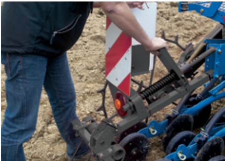
Zagarniacz zapewnia optymalne przykrycie wysianego materiału; nowe rozwiązanie ułatwiające ustawienie docisku i kąta pochylenia, aby stawić czoło wszystkim warunkom pracy. Zęby proste lub w niwelujące, w zależności od modelu siewnika.
