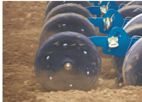
Rolki dociskowe o szerokości 40 mm z 8 pozycjami ustawienia, w tym pozycja całkowitego uniesienia, Stosowane tylko z redlicami talerzowymi UNIDISC.
