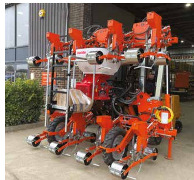
Siewnik STANHAY X30 12-rzędowy (3x4 rzędy) na ramie składanej hydraulicznie
