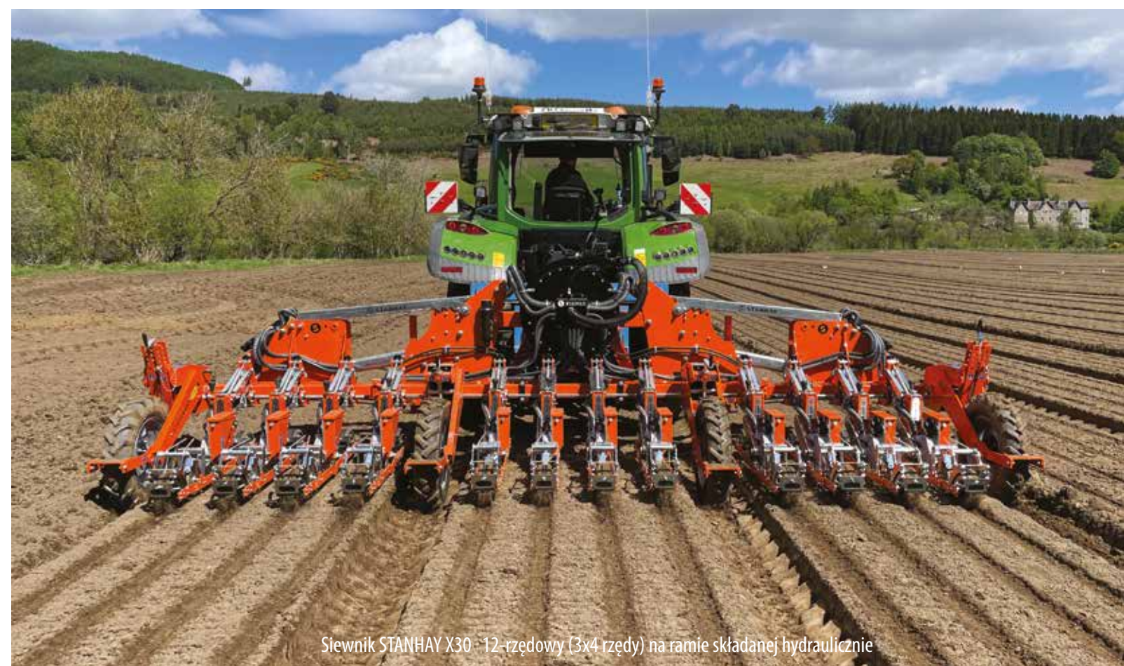
Siewnik STANHAY X30 12-rzędowy (3x4 rzędy) na ramie sztywnej o dużej szerokości
