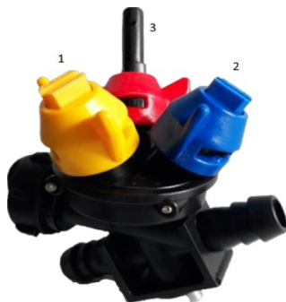
Rys.31. Głowica potrójna. 1-Dysza RS 02; 2-Dysza RS 03; 3- Dysza RSM
