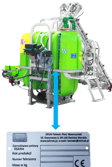
Rys.1. Umieszczenie tabliczki znamionowej na maszynie.
