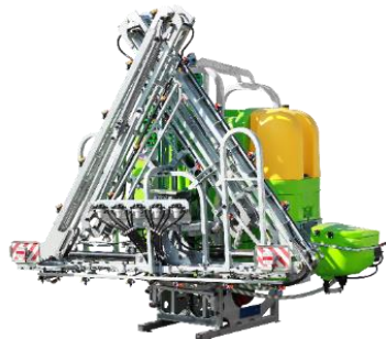
Rys.17. Belka połowa hydrauliczna X - złożona
