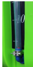
Rys. 5. Miernik wody zbiornika głównego
