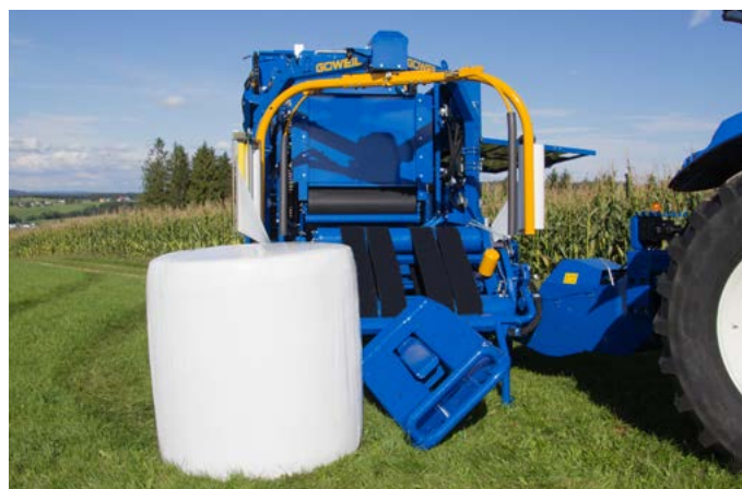
Odkładanie bel z aktywowanym stawiaczem bel
