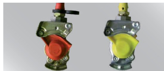
Przyłącze do pneumatycznego układu hamulcowego
