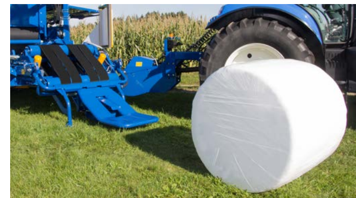
Standardowo kontrolowane odkładanie bel – stawiacz bel dezaktywowany
