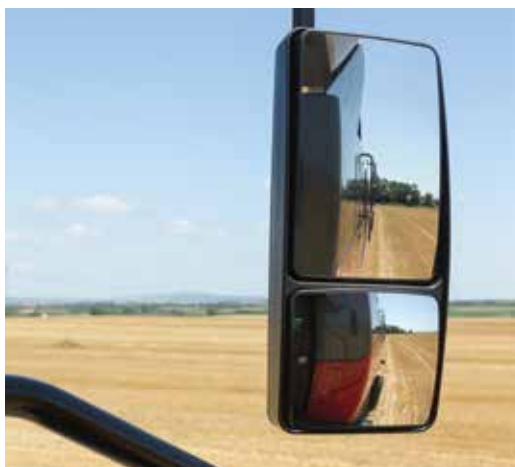
Dwuczęściowe szerokokątne lusterko zapewnia doskonały pole widzenia na boki kombajnu
