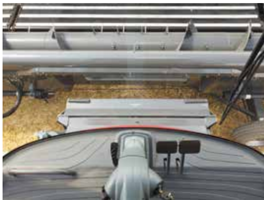
Najlepsze pole widzenia na przenośnik pochyły, ułatwiające szybkie przyczepienie i odczepienie przyrządu żniwnego
