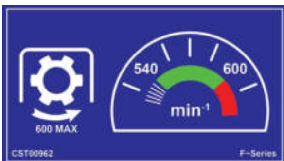
Ustawienie przekładni na 540 obr./min
