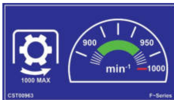
Ustawienie przekładni na 1000 obr./min
