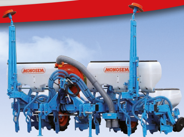
Siewnik NC Technic do kukurydzy, 6-rzędowy na ramie monoblokowej teleskopowej pojedynczej (rozstaw co 75 cm). Podsiewacz do nawozów 2 x 270 litrów, na redlicy stopkowej
