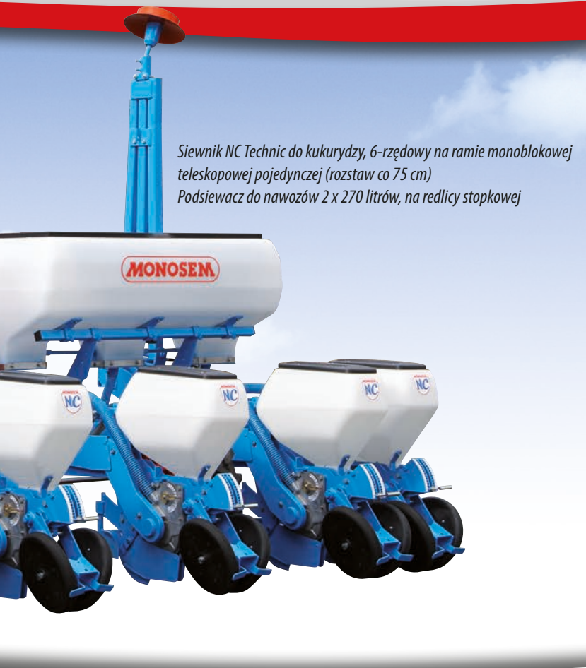
Siewnik NC Technic do kukurydzy, 6-rzędowy na ramie monoblokowej teleskopowej pojedynczej (rozstaw co 75 cm). Podsiewacz do nawozów 2 x 270 litrów, na redlicy stopkowej
