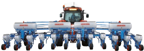
Centralna część ramy jest złożona z ramy podwójnej teleskopowej, ramiona zewnętrzne są zsuwane teleskopowo do szerokości transportowej 3 m (w zależności od wyposażenia).
