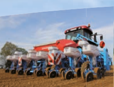
Uniwersalny pneumatyczny, talerzowy siewnik punktowy, Monoshox® NG Plus M
