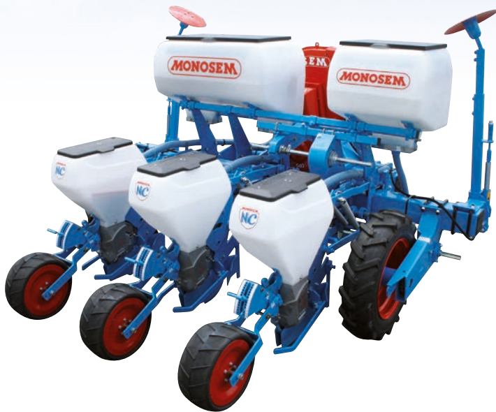
Siewnik NC Technic do kukurydzy - 3-rzędowy, rozstaw co 75 cm
