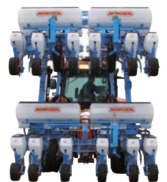
Centralna część ramy jest złożona z ramy podwójnej teleskopowej, ramiona zewnętrzne są zsuwane teleskopowo do szerokości transportowej 3 m (w zależności od wyposażenia).
