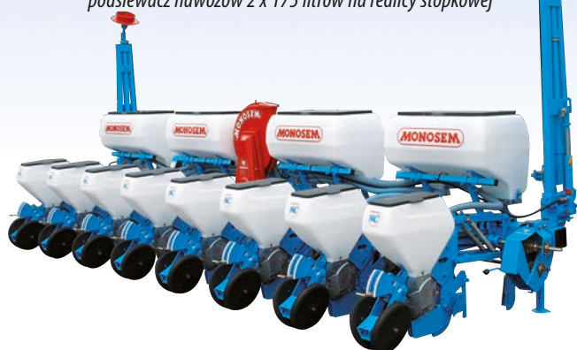
Siewnik NC Technic do kukurydzy, 8-rzędowy na ramie sztywnej jednobelkowej (rozstaw co 70 cm). Podsiewacz do nawozów 4 x 175 litrów, na redlicy stopkowej
