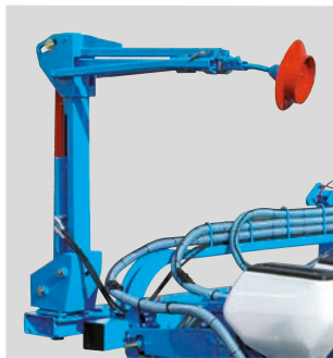
Znaczniki przejazdów montowane na ramach składanych dwubelkowych i składanych CRT umożliwiają uzyskanie minimalnych gabarytów transportowych.
