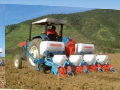
Uniwersalne siewniki pneumatyczne na redlicy stopkowej NC
