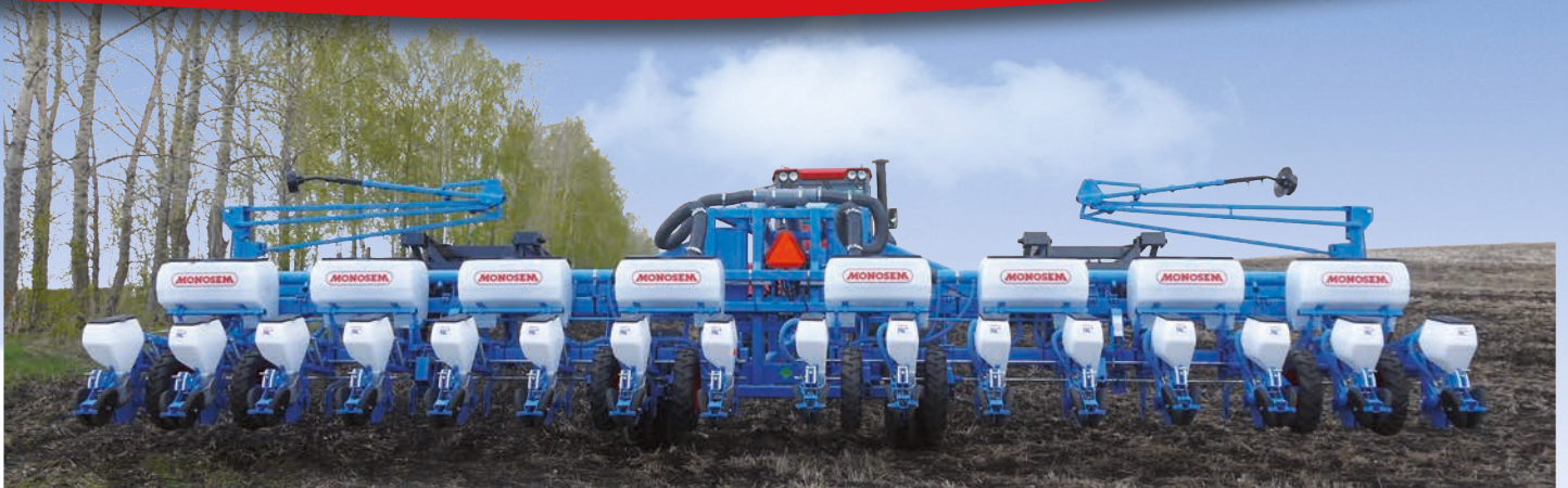
Siewnik NC Technic do kukurydzy - 16-rzędowy, rozstaw co 70 cm
