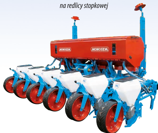
Siewnik NC Classic V3 6-rzędowy na ramie monoblokowej teleskopowej pojedynczej (rozstaw co 75 cm) Podsiewacz ze zbiornikiem o poj. 980 litrów, na redlicy stopkowej
