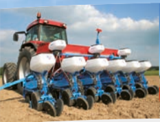
Uniwersalny pneumatyczny, talerzowy siewnik punktowy, NG Plus 4
