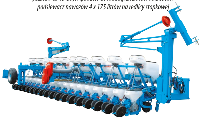
Siewnik NC Technic do buraków 18-rzędowy, na ramie łączącej (rozstaw co 45 cm) Aplikator do mikrogranulatów Microsem i podsiewacz nawozów 6 x 175 litrów na redlicy stopkowej. Wózek transportowy
