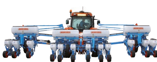
Centralna część ramy jest złożona z ramy podwójnej teleskopowej, ramiona zewnętrzne są zsuwane teleskopowo do szerokości transportowej 3 m (w zależności od wyposażenia).
