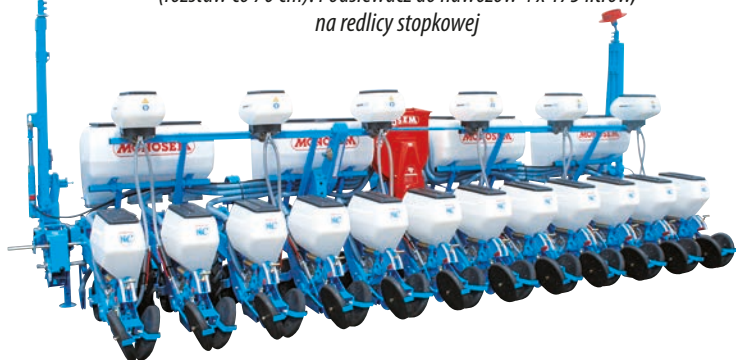
Siewnik NC Technic do buraków 12-rzędowy na ramie sztywnej jednobelkowej (rozstaw co 45 cm). Aplikator do mikrogranulatów Microsem i podsiewacz nawozów 4 x 175 litrów na redlicy stopkowej
