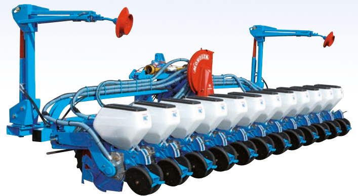
Siewnik NC Technic do kukurydzy, 12-rzędowy, na ramie składanej dwubelkowej (rozstaw co 45 cm).
