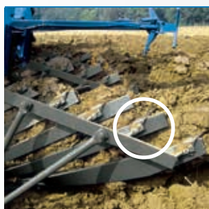
Rozdrabniacz grudek pozwalający na dokładniejsze rozdrobnienie gleby (tylko dla odkładnic ażurowych).
