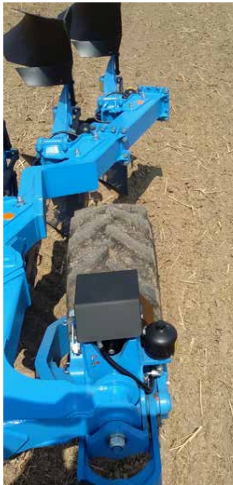
Siłownik podnoszenia pługa przy kole jest wyposażony w amortyzator hydropneumatyczny, który pozwala tłumić drgania podczas transportu i wydłużyć żywotność pługa. Regulacja głębokości odbywa się za pomocą śruby regulacyjnej.
