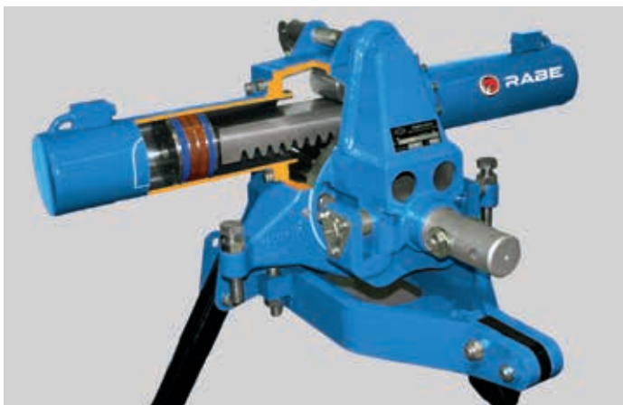
Mechanizm obrotu koło zębate – listwa zębata. Nie ma martwych punktów w procesie obracania pługa jak ma to miejsce na licznych innych układach, które działają z wykorzystaniem dwóch siłowników hydraulicznych.
