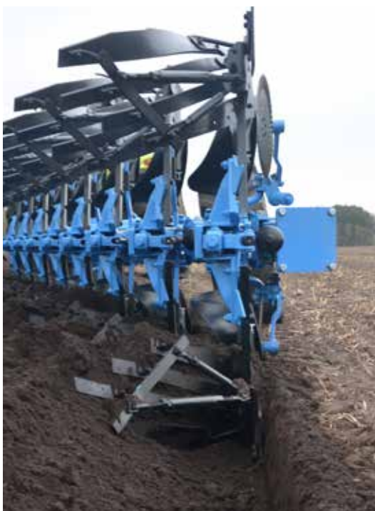
Mechanizm obrotu koło zębate – listwa zębata. Nie ma martwych punktów w procesie obracania pługa jak ma to miejsce na licznych innych układach, które działają z wykorzystaniem dwóch siłowników hydraulicznych.
