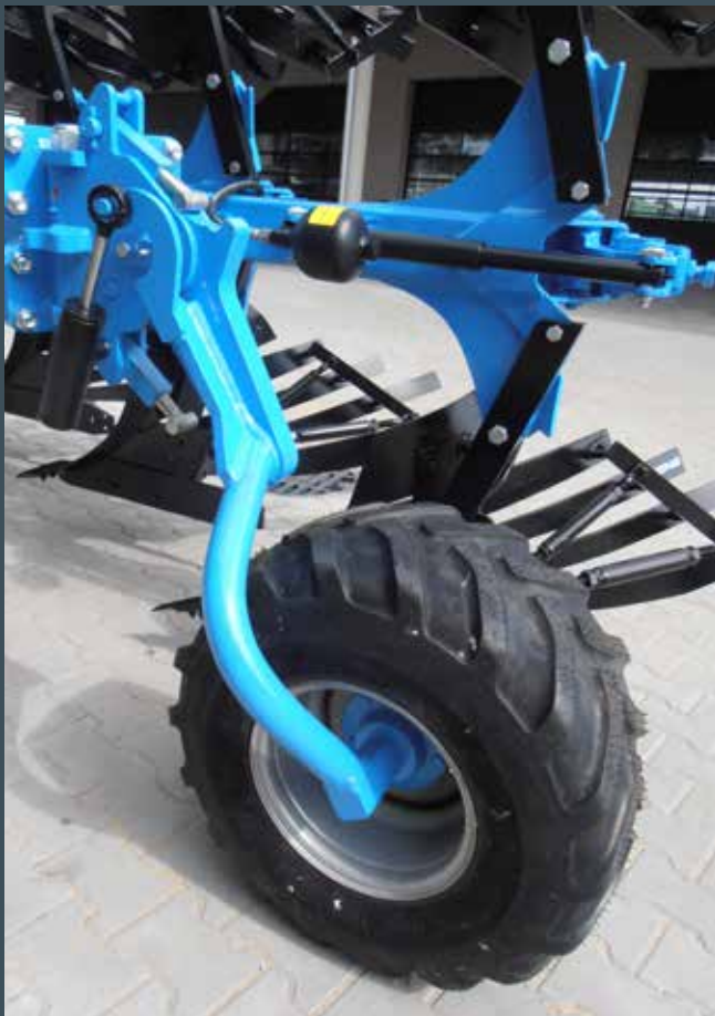
Szerokie tylne koło o wymiarach 320/60x12 (Ø 690 x 320 mm) wyposażone jest w amortyzator, który powoduje łagodne opadanie koła po obrocie pługa.
