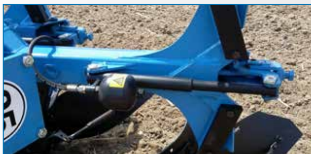
Zabezpieczenie non-stop hydrauliczne Hydro-Avant z dodatkową śrubą ścinającą
