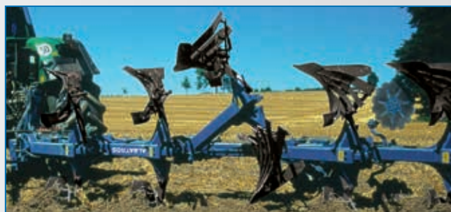
Możliwość odchylenia korpusu do góry i na bok
