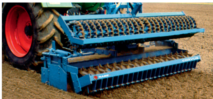
Wał Crosskill (Ø 44 cm) zamocowany na tylnym trójpunktowym zaczepie hydraulicznym, wspomagający pracę wału głównego
