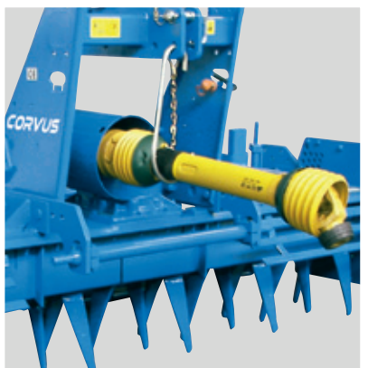
Walek odbioru mocy (WOM) ze sprzęgłem czernym (model PKE) lub sprzęgłem przesuwnym (model VKE)
