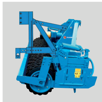
Możliwość montażu bronny wirnikowej z przodu ciągnika
