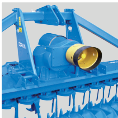
Przekładnia główna z wymiennymi kołami zębatymi, możliwość montażu tylnego waleka przekaźnika mocy (opcja)
