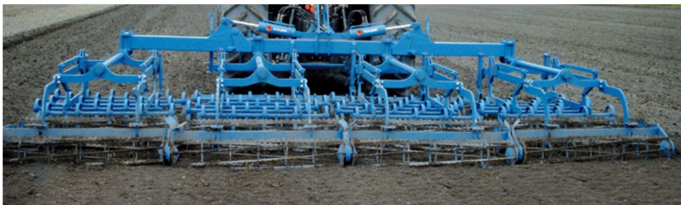
Specjalna konstrukcja podwójnego wału strunowego (przesunięcie pierwszego wału względem drugiego) pozwala na pracę całą szerokością wałów bez przerw między elementami.
