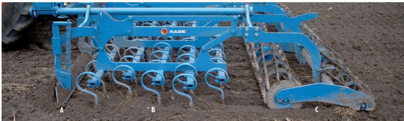
A. Włoka wyrównująca montowana na sprężynach z mechaniczną regulacją wysokości (opcja: regulacja hydrauliczna) B. Zęby montowane na równoległoboku z precyzyjną mechaniczną regulacją głębokości C. Podwójny wał strunowy (Ø 33 cm i 27 cm) z łożyskami kulowymi
