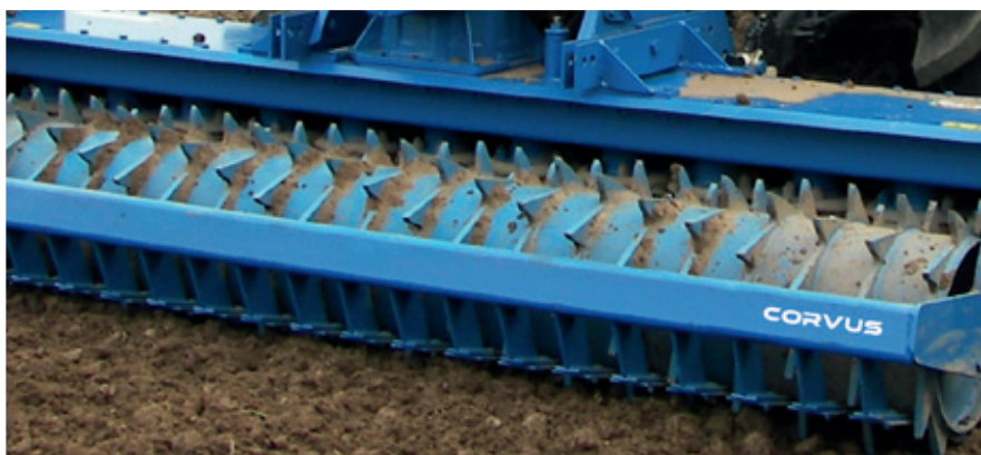
Wał Packer (Ø 51 cm). Składa się z precyzyjnie wykonanej stalowej rury z przyspawanymi, hartowanymi zębami. Wał uniwersalny szczególnie dobrze sprawdzający się na mokrych lub zakamienionych glebach
